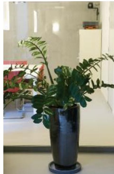
Glaspanelen van vloer tot plafond zijn slecht zichtbaar. De oplossing kan soms eenvoudig zijn.
